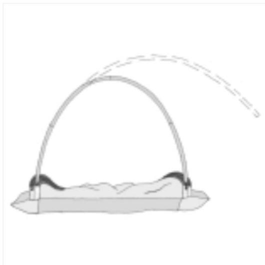
8. Das Rohr mit dem Reißverschluss befestigen und dabei die Kanten des Reißverschlusses und des Zeltens glätten.
